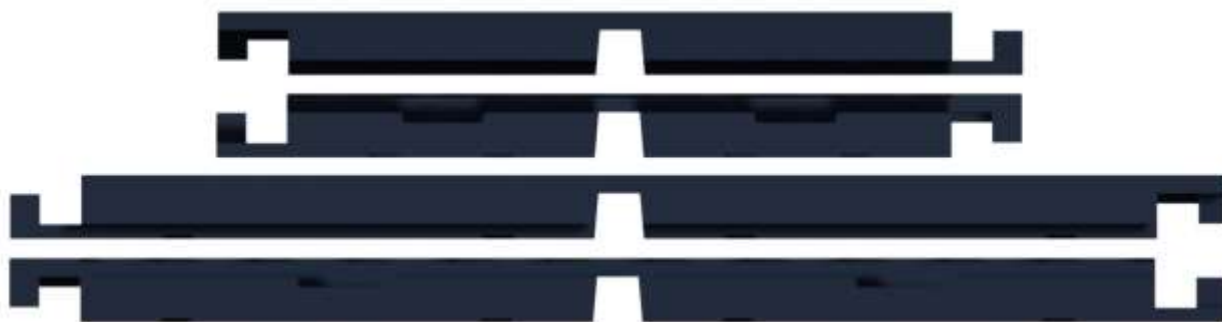
Figur 7.4 Profilbild över gångplattans fyra sidor. Överst i bild är de två kortsidorna och undertill de två långsidorna. I bilden framgår tydligt kabelkanalernas placering i mitten på varje sida, samt utformningen av sammankopplingsfästen.
