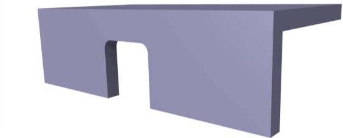
Figur 5.27 - Kabelkanalsöppning förslag 2, kvadratisk öppning med rundade hörn.
