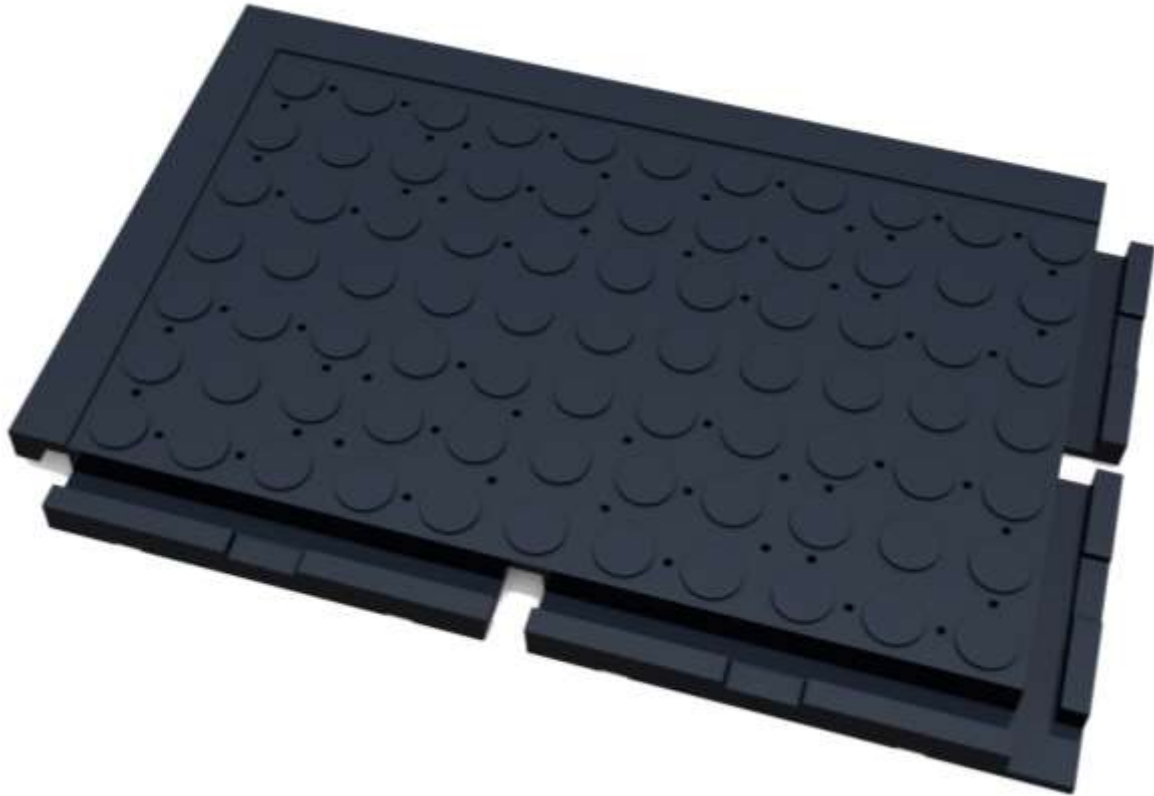
Figur 7.1 Perspektivbild på golvets ovasida. På bilden syns cirkelmönstret, dräneringshålen, ingången till kabelkanaler samt spåren för sammankoppling. I upphöjningen av spåren syns även de små nedsänkningar som skall förhindra att plattorna glider i sidled.
