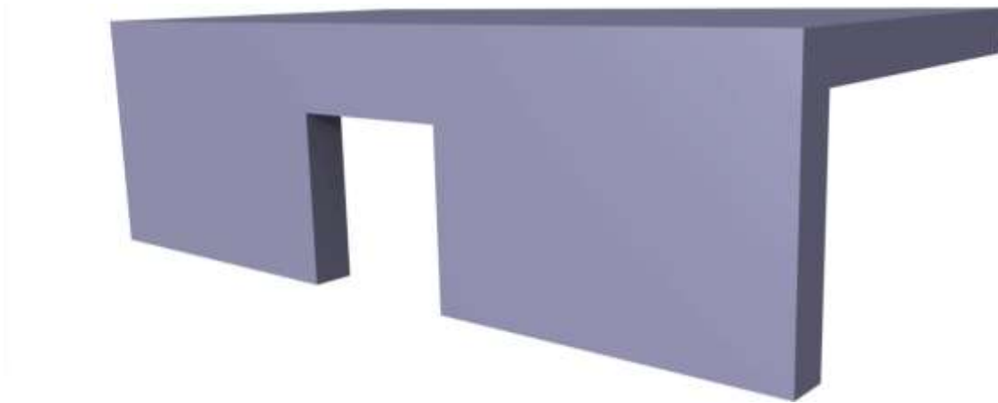
Figur 5.26 Kabelkanalsöppning förslag 1, kvadratisk öppning.
