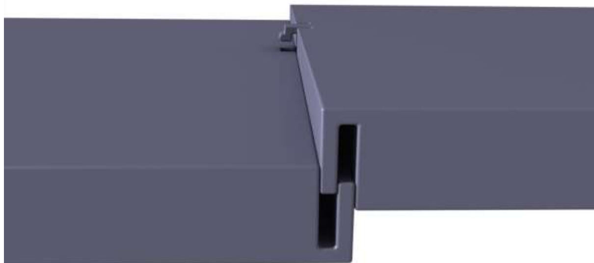
Figur 5.11 Sammankopplingsanordning förslag 6, vy från sidan.
