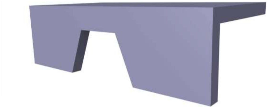
Figur 5.28 Kabelkanalsöppning förslag 3, öppning med lutande väggar.
