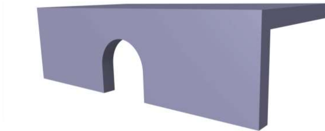
Figur 5.30 Kabelkanalsöppning förslag 5, öppning med halvcirkelformad profil upptill.
